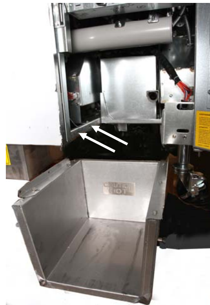
1. ábra: Helyette el az olvasztót a szekrényben, majd a csomagban található csavarok segítségével rögzítse a szekrény belső részéhez.
